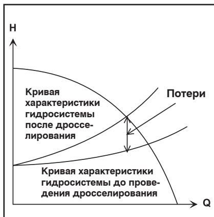
Рис. 25 Потери при регулировании подачи с помощью дроссельного клапана
